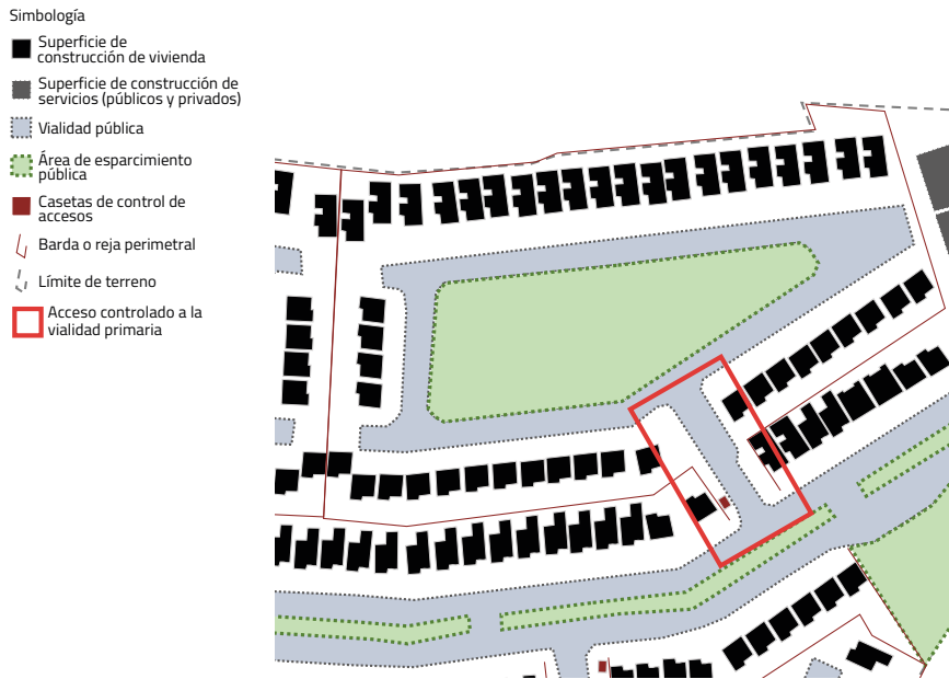
Ilustración 13: Diagrama del desarrollo en Mérida poniente, Yucatán, que ejemplifica una traza cerrada con control de acceso
