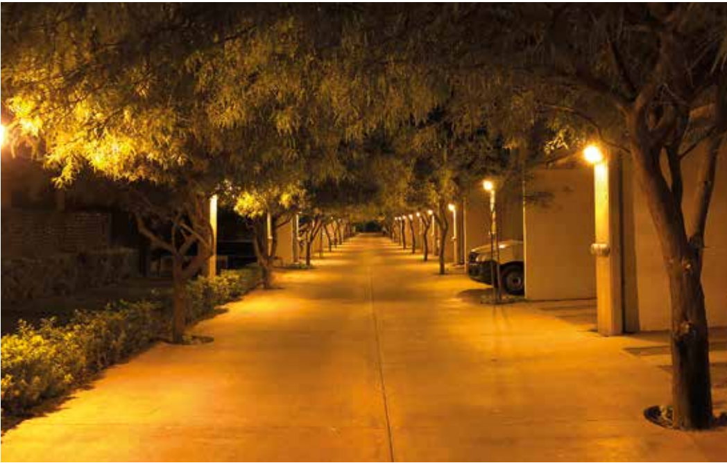
Vialidad de bajo impacto estrecha y sin banquetas en la que los automóviles circulan a baja velocidad y los peatones transitan como en un andador
