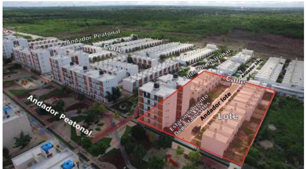
Ilustración 28: Extensión de andadores, vialidades secundarias (calle) y vialidades de bajo impacto (andador lote) en el conjunto estudiado en Mérida sur, Yucatán
